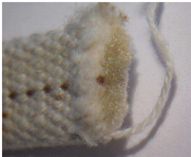
Abb. 5: Spezialdocht einer Feuerhand „Baby Special“ 276 StK 70-Stunden (Foto D. Bunk)
